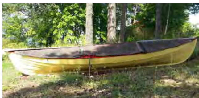
Spissbåt med utriggere bygget av K. Holland Båtbyggeri på Hamar, her lagret på stranden på tradisjonelt vis med kjølen mot bakken og snekret båtakk. Foto: Sigurd Nielsen, Mjøsbåtarkivet.
